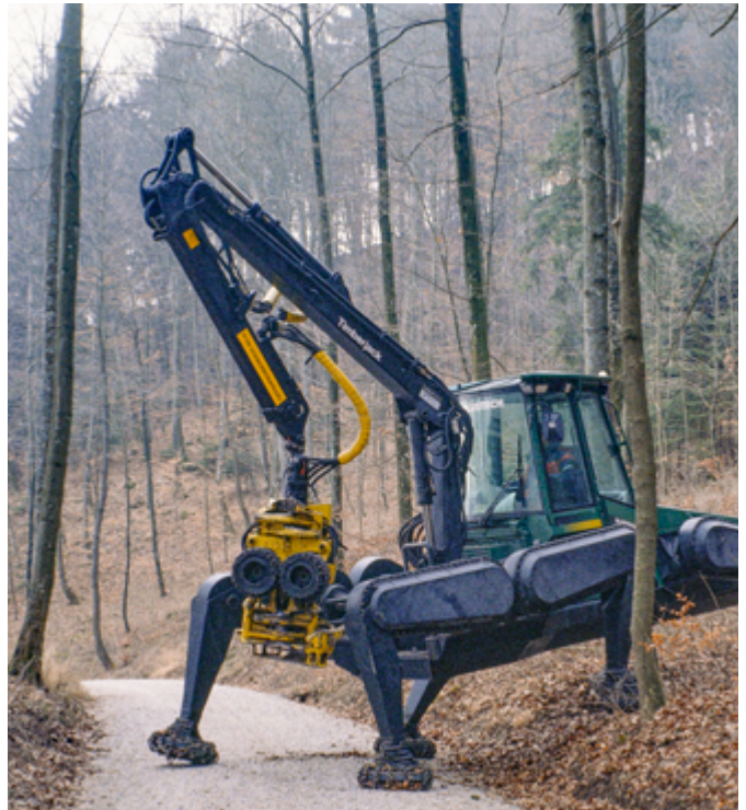
1997 testete die WSL ein urtümlich anmutende Waldmaschine, eine sogenannte Schreitmaschine, hier in Wettingen/AG.
